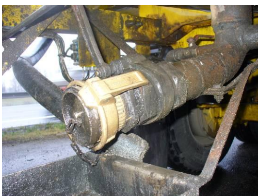
Únik nebezpečné látky UN 3082 z prostoru výpustného potrubí.
