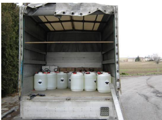
Kusová přeprava nebezpečných látek bez upevnění nákladu proti posunutí a pádu.
