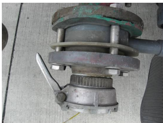
Nepatřičně uzavřené uzavírací zařízení na konci výpustného potrubí cisternového vozidla. Kontrola povinné výbavy v nevalné kvalitě
