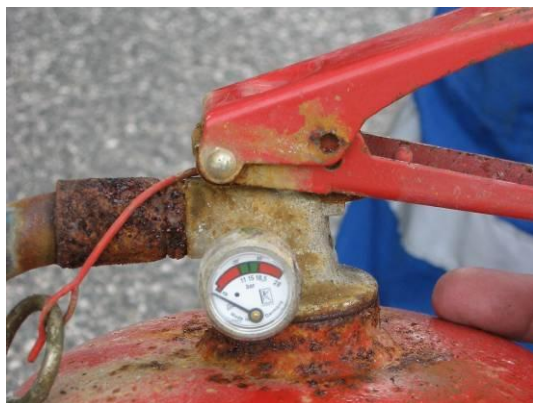
Nefunkční hasicí přístroj a hasicí přístroj s prošlou lhůtou kontroly.
